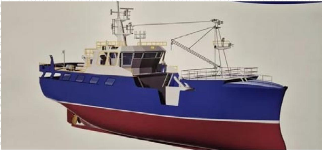
*Diseño del innovador palangrero con un sistema híbrido de propulsión de 36,37 metros de eslora.*
